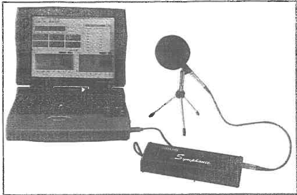
Vue d'ensemble du sonomètre 01dB modèle Symphonie
