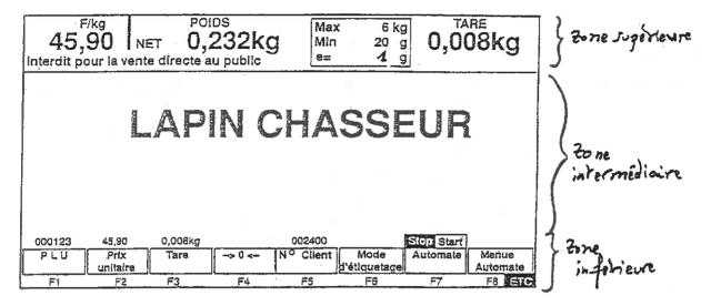
Lors de cette séquence d'écran, un appui sur la touche «F4» commande le dispositif semi-automatique de mise à zéro, un appui sur la touche «ETC» donne accès à une seconde ligne de commande pour les «touches logicielles» et la touche «F6» appelle un sous-menu permettant de choisir le mode de fonctionnement (poids, prix fixe, poids fixe ou poids fixe/prix fixe).
