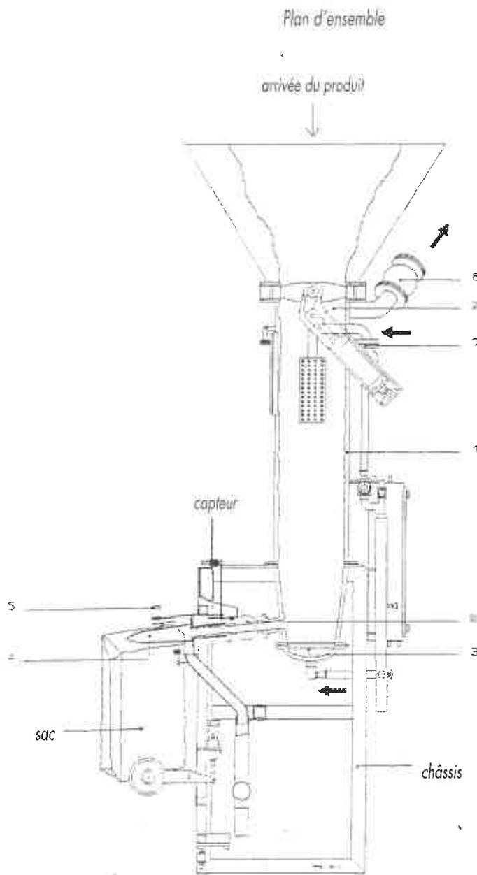
La chambre (1) se remplit de produit par l'intermédiaire de la vanne papillon (2) en position ouverte. Le produit est fluidisé sous l'action de l'air à basse pression qui pénètre par un diffuseur en matière poreuse (3) situé dans le fond de la chambre.
