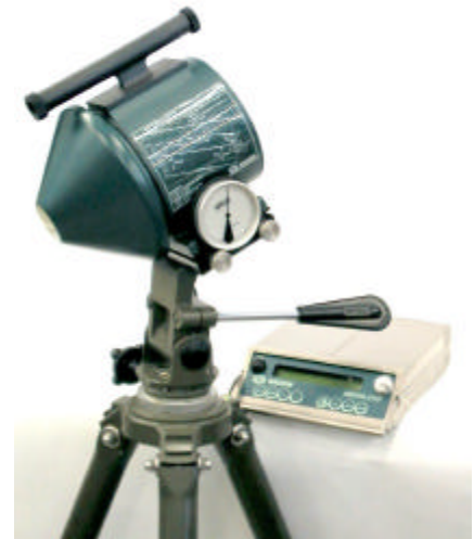
Dispositif de mesure de l'inclinaison
