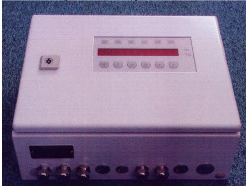
**Schéma du dispositif de totalisation, des visualisation et des commandes**
